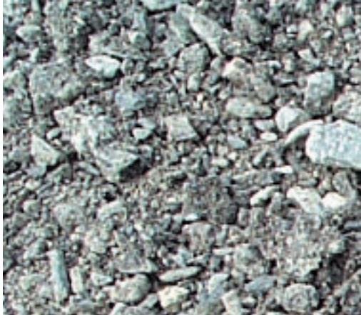
△ Knust asfalt før utlegging og kompaktering
